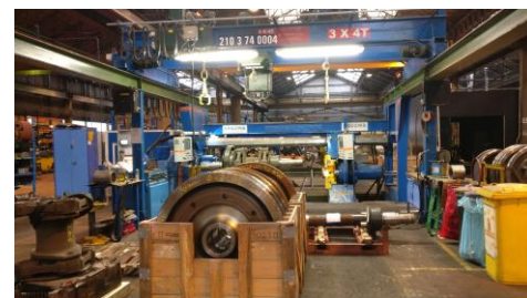
Une paire de roues et leur essieu avant montage
